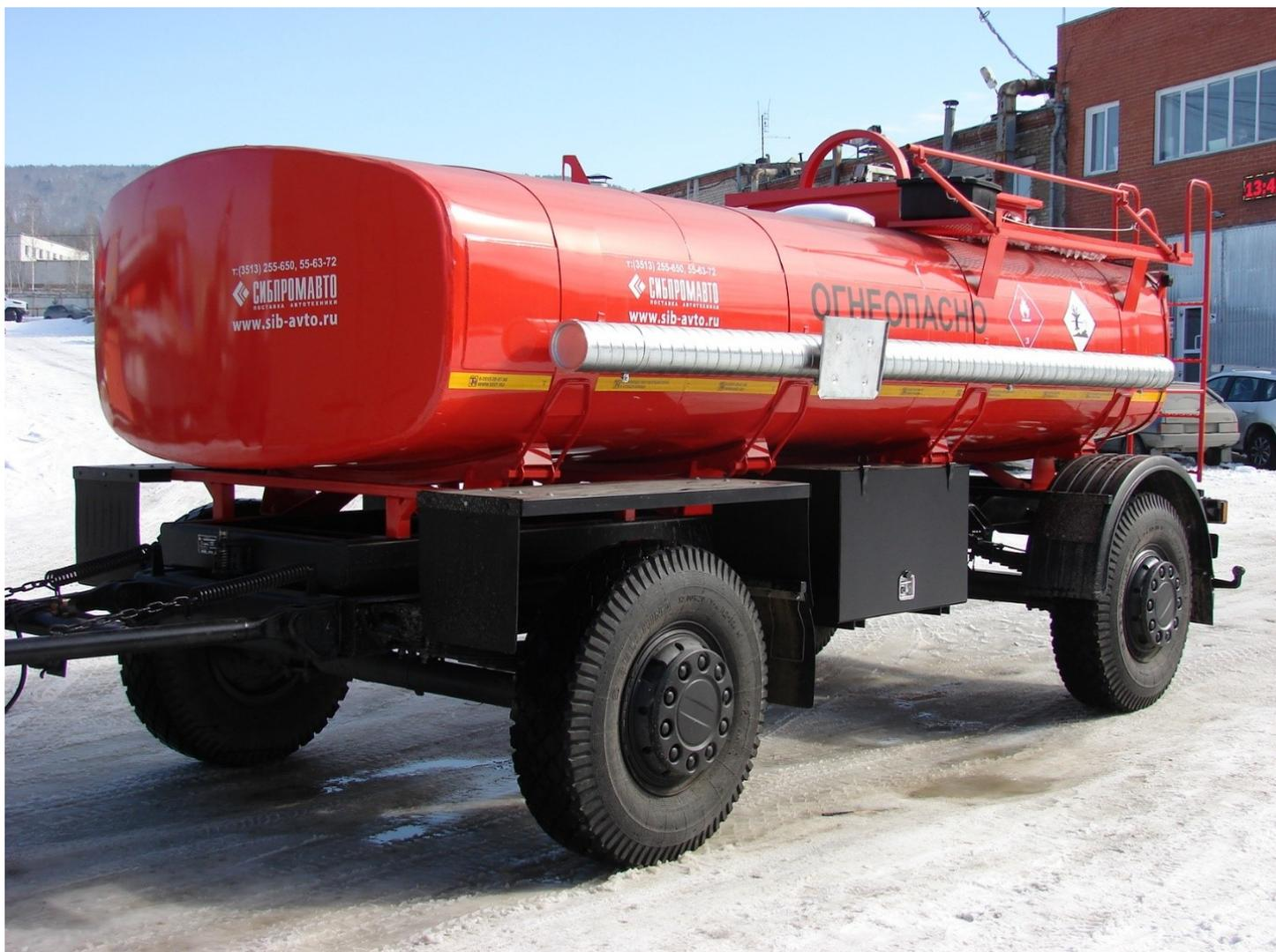
Стальной корпус имеет чемоданную форму сечения. Для снижения силы гидроударов на днища при изменении скорости движения прицеп оснащен волнорезами. Для исключения образования «воздушных мешков» при заполнении цистерны топливом в верхних углах корпуса цистерны установлены воздухопроводные трубки. В нижней части емкости прицепа имеется отстойник для сбора имеющейся в топливе влаги и механических примесей.
