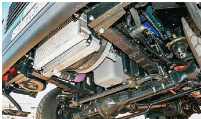
Защита двигателя снизу не предусмотрена за ненадобностью – от земли до картера более полуметра
