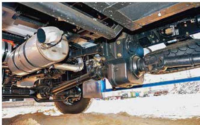
Новое размещение раздаточной коробки позволило сохранить оптимальный угол карданных валов
