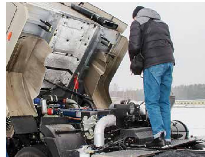
Кабина поднимается на 60 градусов, открывая доступ к двигателю. Есть и удобные металлические площадки
