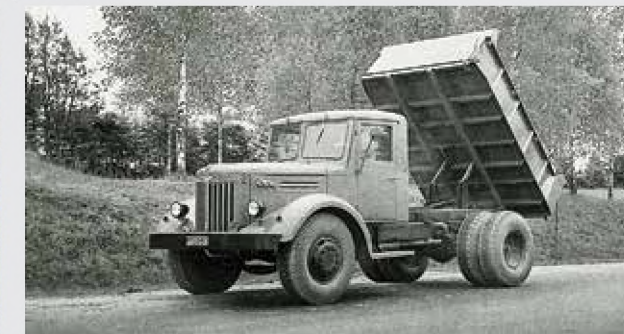
МАЗ-205 с металлической обшивкой кабины. Именно такие машины стали наиболее массовыми
