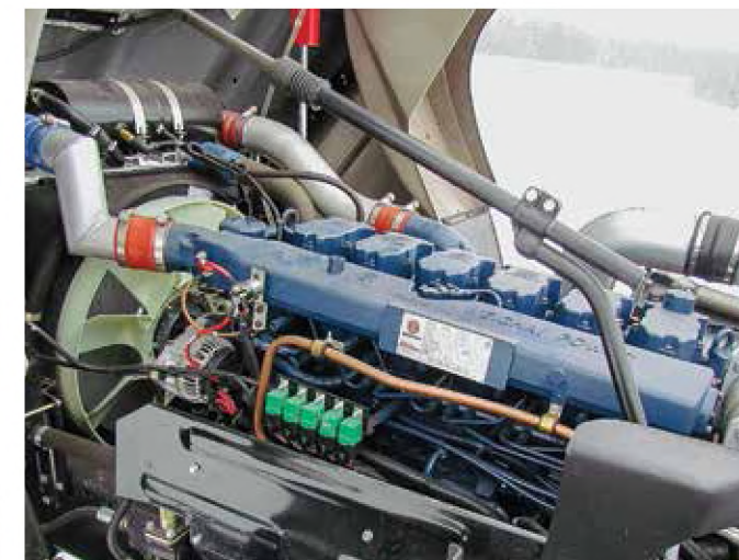
Двигатель WP12.430E мощностью 430 л.с. прекрасно встал под кабиной седельного тягача МАЗ-6430
