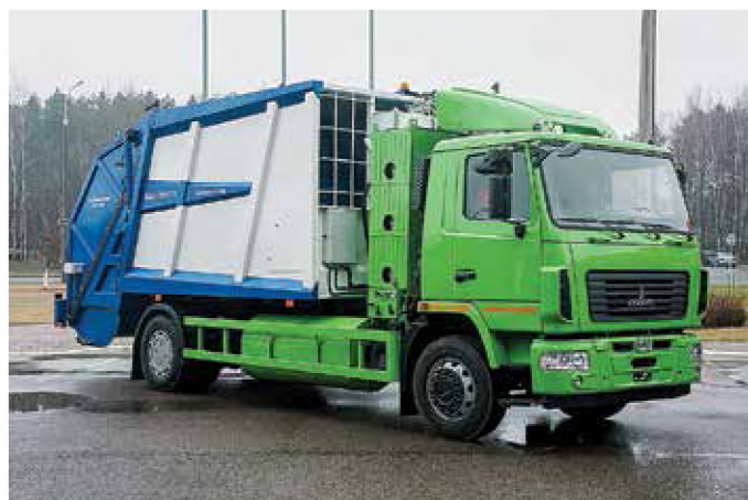
Мусоровоз МАЗ-590423 «Сапфир-Эко» на шасси МАЗ-534023-520-030 с увеличенным до 1128 л запасом газа
