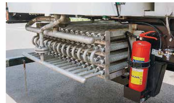
Огромный «змеевик» в заднем свесе под цистерной – конденсатор-испаритель
