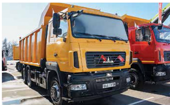
Самосвал МАЗ-650128-8570 с рядной «шестеркой» WP 12.430E50 экологического класса Евро-5
