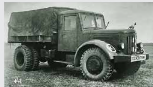
ЯАЗ-200. Тентованный кузов – особенность экземпляра, проходившего контрольные испытания в 1949 году
