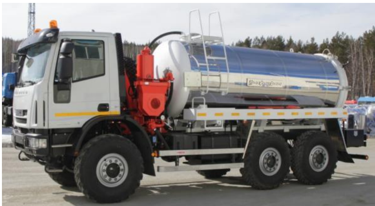
Агрегат для сбора конденсата нефти АКН-12
