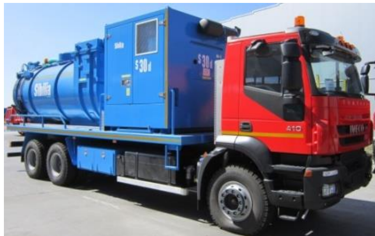
Вакуумная установка для сбора нефти
