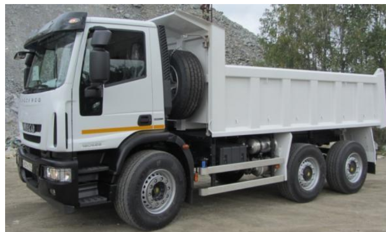
Самосвал 6x4 полной массой 23 тонны
