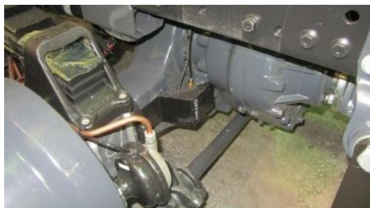
Защита датчиков мостов
