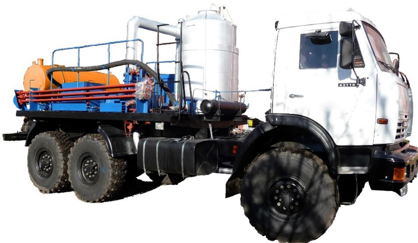
Агрегат АДПМ-12/150 предназначен для депарафинизации скважин горячей нефтью, а также для других технологических операций, где требуется подача продавочной жидкости под высоким давлением в условиях холодного и умеренного макроклиматических районов. Наличие технологических и вспомогательных трубопроводов дает возможность быстро подключать агрегат к скважине и емкости с нефтью. Агрегат легко запускается в работу, нефть нагревается до установленной температуры за 20 мин. с момента пуска.
