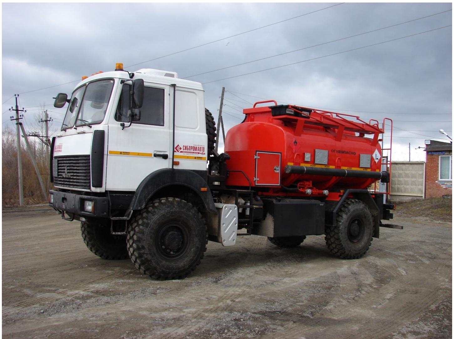
Автотопливозаправщик АТЗ-8- предназначен для транспортирования, кратковременного хранения и заправки светлыми нефтепродуктами автомобилей, различных механизмов и машин. Раздача нефтепродуктов осуществляется при помощи насоса СВН-80
