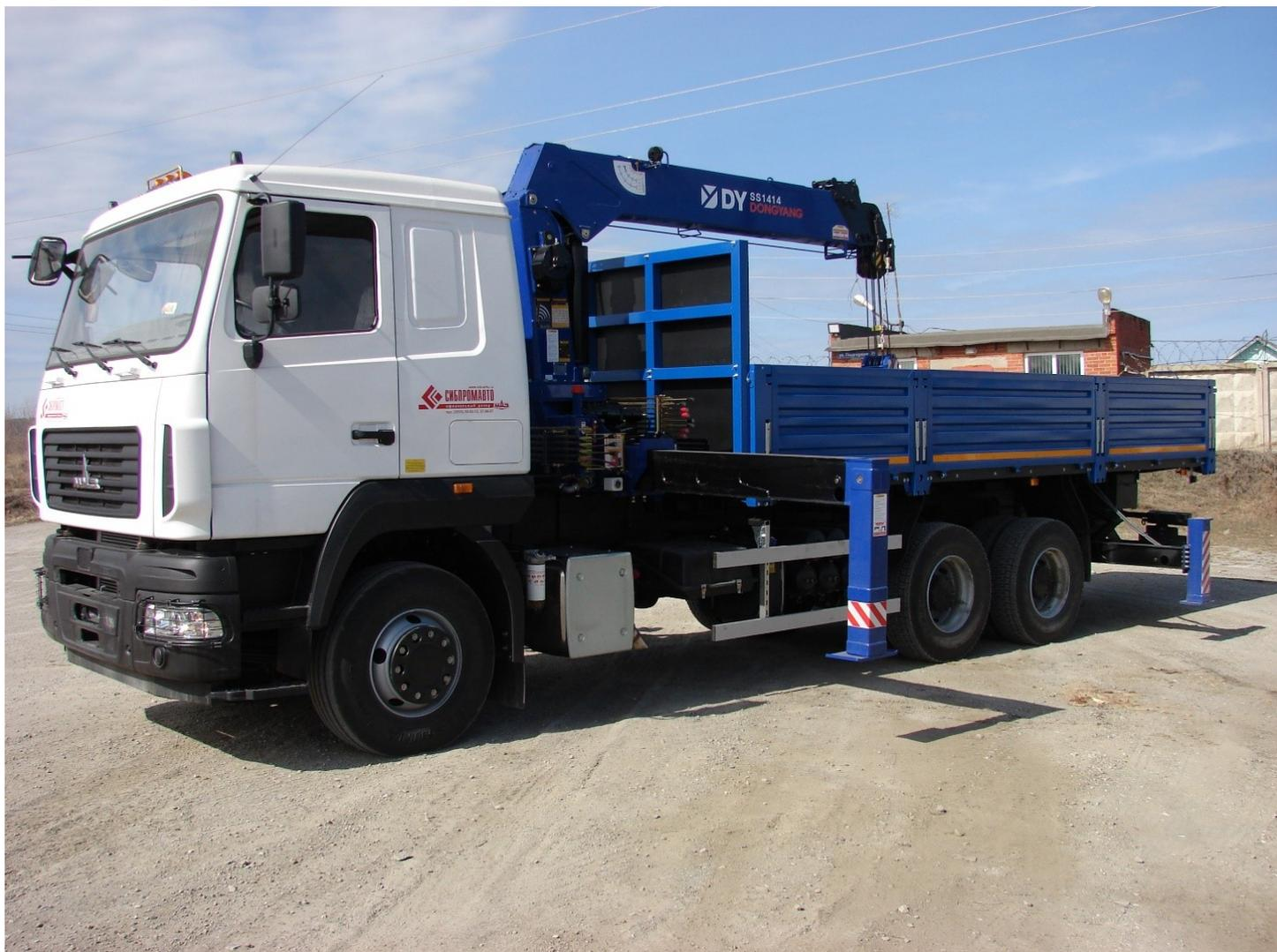
Бортовой МАЗ 631228-8575-012 с КМУ DongYang SS1414 используется для выполнения строительных и монтажных работ, а также для транспортировки грузов на малые и средние дистанции. Маневренный грузовик оборудован двигателем класса ЕВРО 5 обладающим мощностью 430 л.с. и 12-ступенчатой механической КПП.
