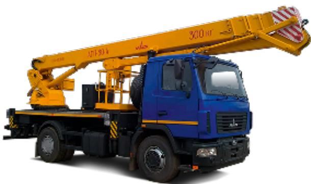
Предназначены для технического обслуживания электроустановок, линий электропередач, проведения ремонтно-декоративных работ. Колесная формула 4x2.
